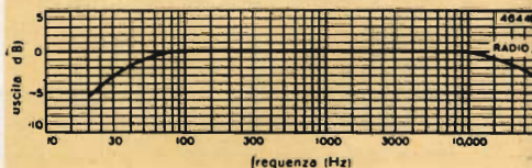
Fig. 13 - Risposta in frequenza del preamplificatore stereofonico quando il segnale d'ingresso proviene dal sintonizzatore a modulazione di frequenza.
